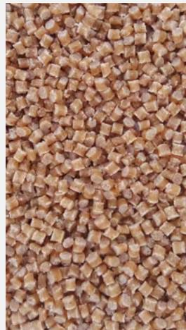
**Biofibra®** - una gama de biopolímeros biodegradables fabricados íntegramente con materiales de carbono de base biológica. Sus propiedades mecánicas, como la rigidez o la flexibilidad, pueden ajustarse a los requisitos del cliente. Asimismo, pueden procesarse con equipos convencionales de fabricación de plásticos.t.
